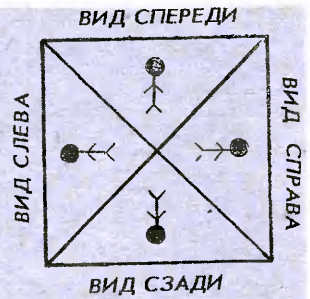
Рис. 3. Условное изображение, наблюдаемое в смотровом окошке четырехстороннего перископа.
